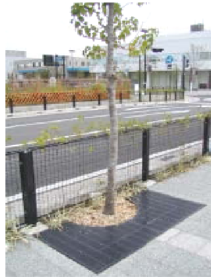
図 2-1-2 踏圧防止盤による植樹ますとトレリス
